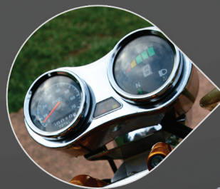
Painel: Velocímetro, odômetro e marcador de marchas digital
